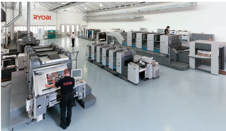
Blick in den Show-room der Illies Graphik GmbH. Hier ist u.a. auch eine Ryobi 920 mit LED-UV-Trocknung installiert.
