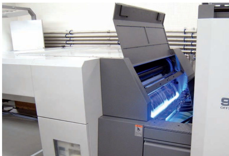
Der LED-UV-Trockner von Ryobi, auf unserer Abbildung in eine Maschine aus der 920er-Serie integriert.
