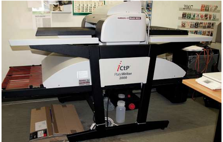
Das PlateWriter-System bei HT Offset. Dazu gehört auch die weitere Verarbeitung in der Finisher-Station, die sich direkt unter dem Drucker befindet. Dort wird die Druckplatte getrocknet, fixiert und anschließend gummiert.
